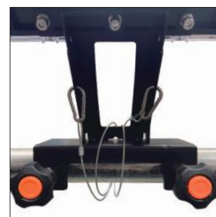
落下防止ワイヤー設置時
